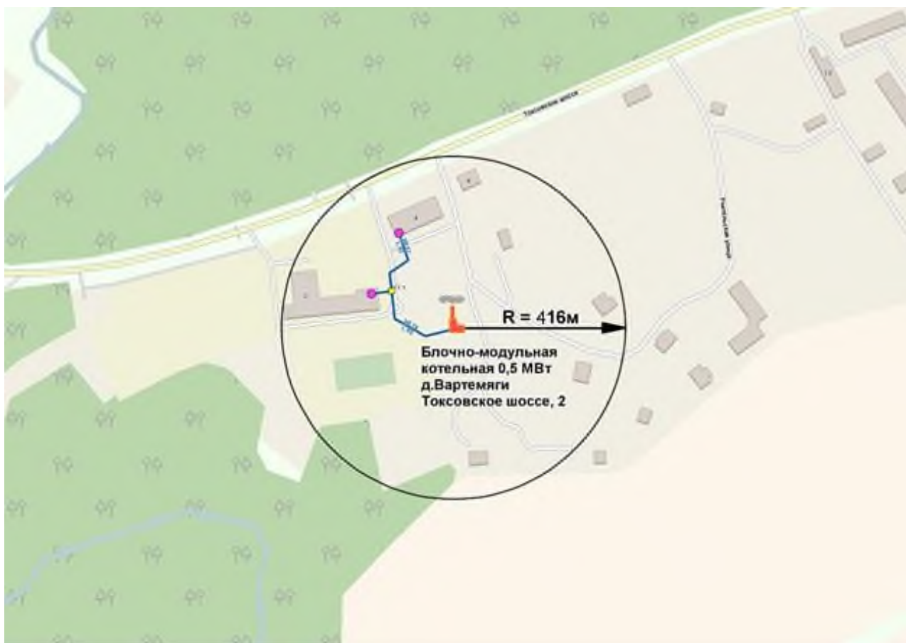
Рисунок 40. Радиус эффективного теплоснабжения от источника т/эн д.Вартемяги
